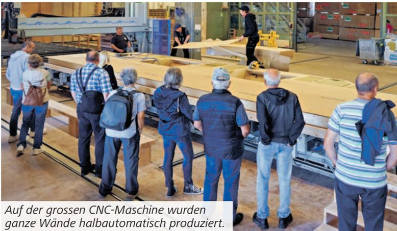
Auf der grossen CNC-Maschine wurden ganze Wände halbautomatisch produziert.
